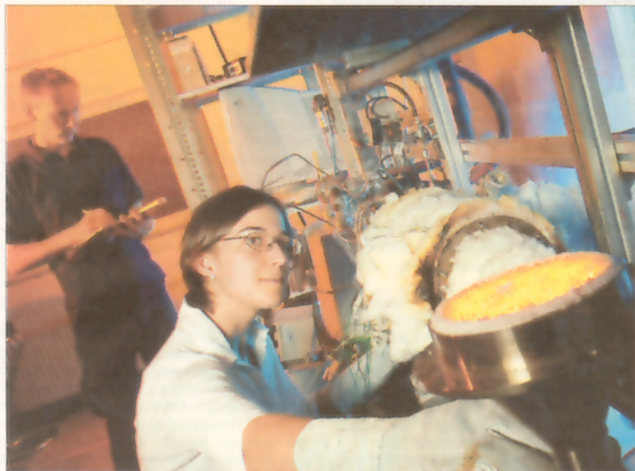
Die Erlanger Promeos GmbH hat eine Technologie entwickelt, die Heizungen effizienter macht. Sie nutzt Reaktoren aus einer Spezialkeramik. Foto: Kurt Fuchs
